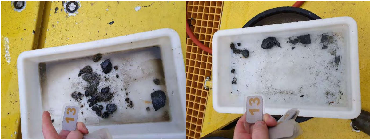
Figur 17: Bilder som viser sedimentet fra ekstrastasjon 13 før og etter siling. Sedimentet besto av silt. Foto: Aqua Kompetanse AS.
