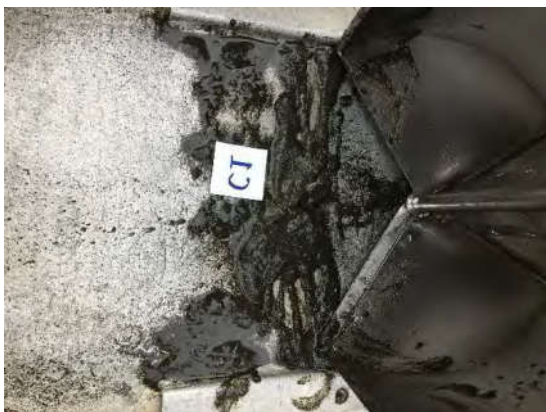
Figur A-1: Bilde av sedimentet ved C1. Sedimentet besto av silt og noe leire og grus. Prøven hadde en pelittandel på 54,8% (se Eurofins rapport i Vedlegg C ). Foto: Aqua Kompetanse AS.
